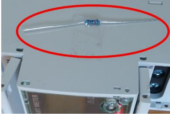
Την τερματική αντίσταση 120 Ohm θα την βρείτε κολλημένη πάνω στον Fronius Smart Meter
