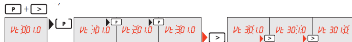
Παράδειγμα εισαγωγής λόγου μετασχηματισμού Μ/Σ τάσης
