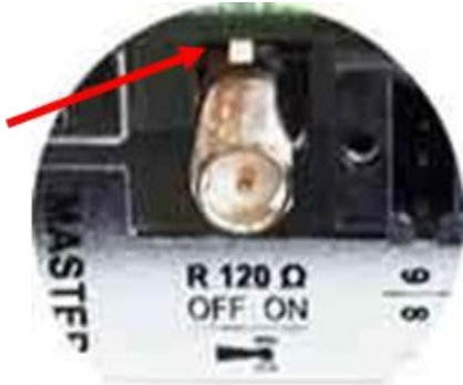
Ενεργοποίηση της τερματικής αντίστασης 120 Ohm στην κάρτα Datamanager 2.0 του μετατροπέα
